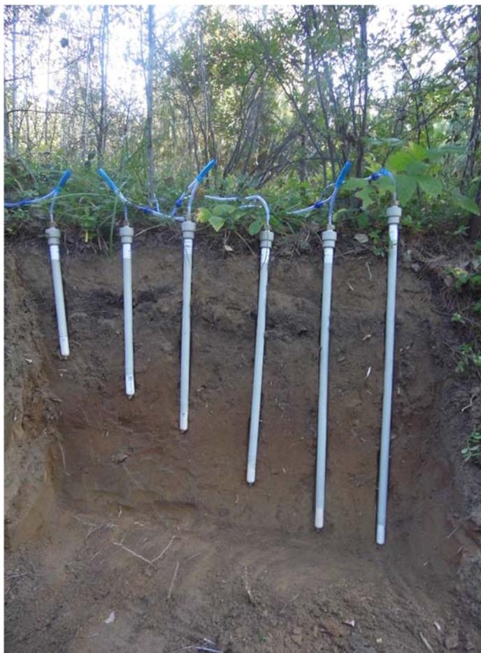
Рис. 1. Вид расположения лизиметров в глубине почвенного профиля /
