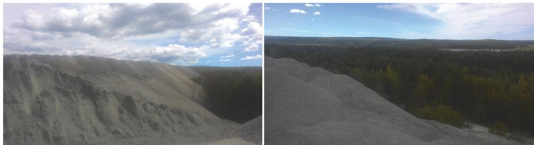
**Рис. 2.** Отвальные массивы отсевов дробления
