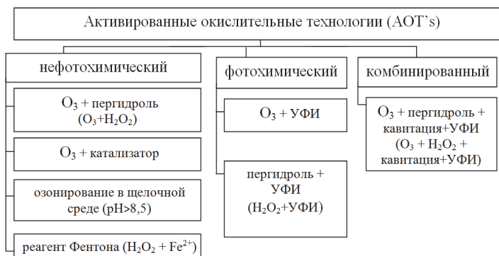
Рис. 1. Классификация активированных окислительных технологий (AOT's)
