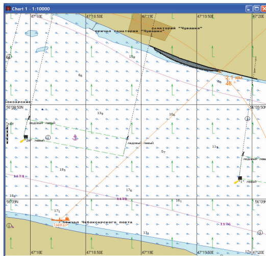
Рис. 6. Карта чрезвычайной ситуации на четыре часа с момента разлива нефти при южном (180) направлении ветра [Figure 6. Map of the emergency for four hours from the moment of oil spill in the south (180) direction of the wind]
