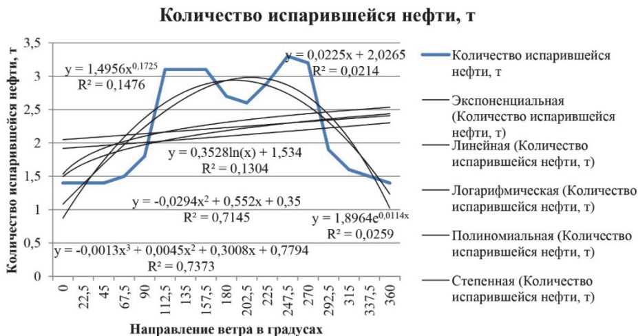
Рис. 7. Зависимость количества испарившейся нефти от направления ветра
