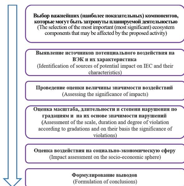
Рис. 2. Алгоритм проведения комплексной оценки воздействия на окружающую среду при эксплуатации опытно-промышленной установки ОАО «Ресурсы Малого Хингана» [Figure 2. Algorithm for conducting a comprehensive environmental impact assessment during the operation of a pilot industrial installation of Maly Khingan Resources, JSC]
