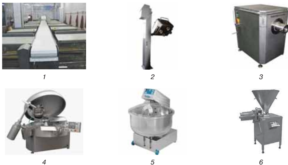
Рис. 2. Основное шумящее оборудование, применяемое в мясоперерабатывающих цехах:
