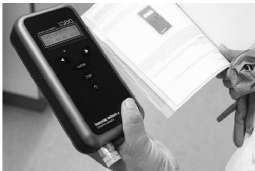
**Рис. 1.** Переносной диффузионный классификатор DISCmini
