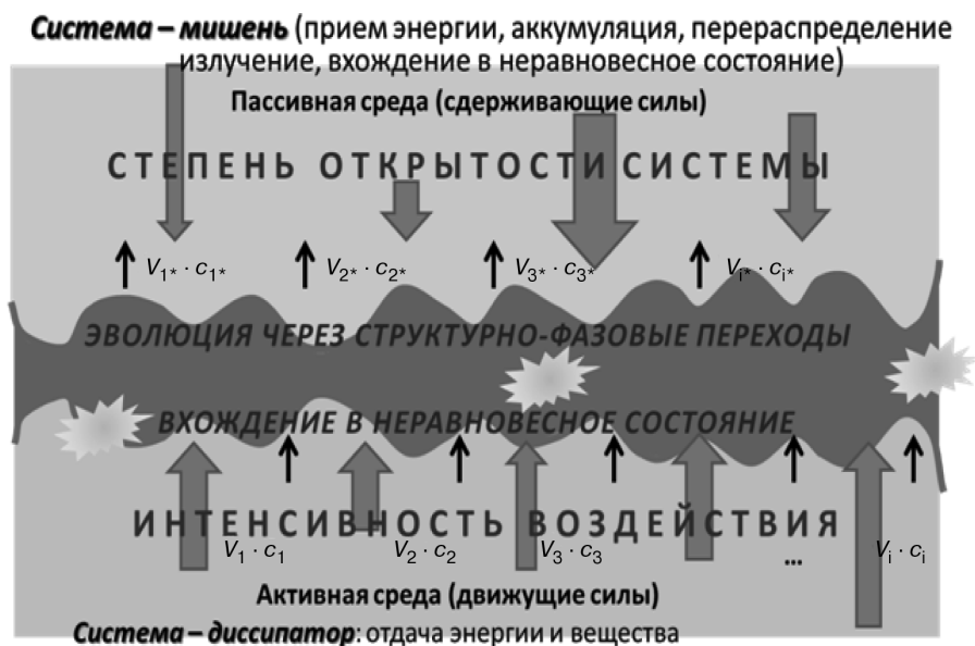
Рис. 1. Теоретическая модель возникновения автоколебаний при взаимодействии активной и пассивной сред
