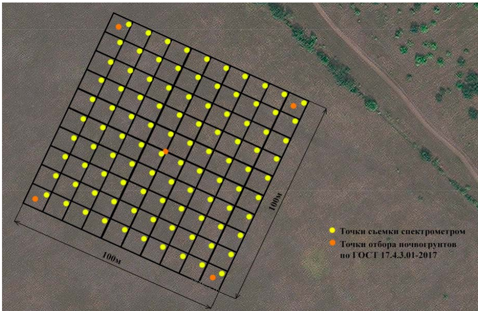
Рис. 3. Схема съемки спектральных данных и отбора проб почвогрунтов Источник: составлено автором.
