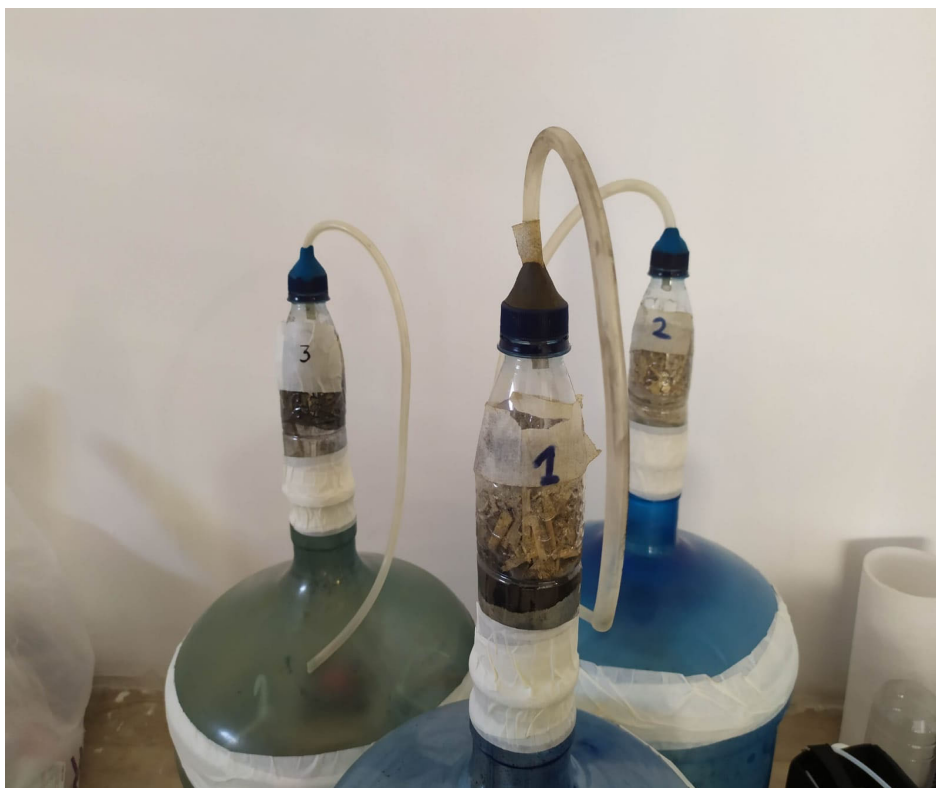
Рис. 2. Общий вид биосорберов с органической загрузкой Источник: фотография автора.
