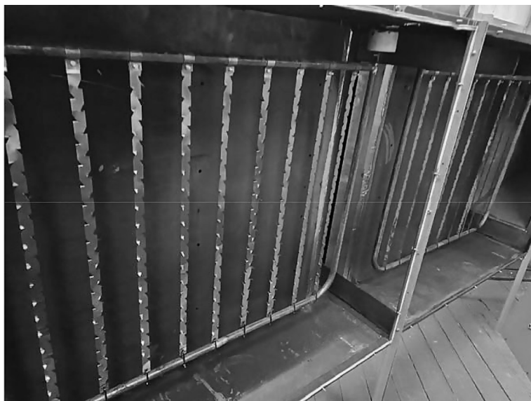
Рис. 1. Лабораторный электрофильтр со снятым осадительным электродом
