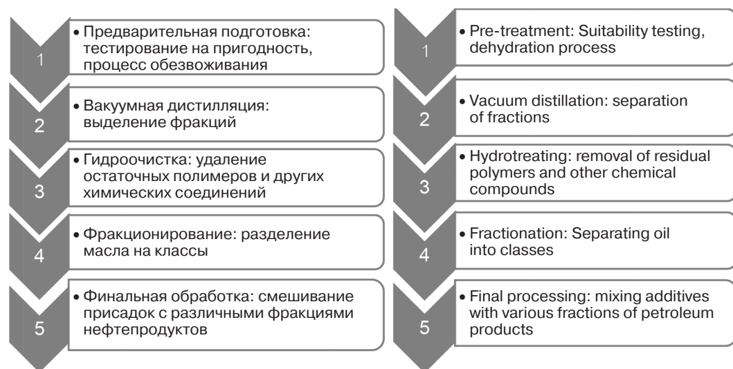
Рис. 2. Этапы технологических операций переработки
