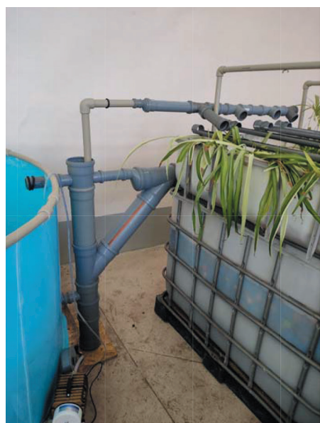
Рис. 1. Вермибиофильтрационный модуль очистки оборотной воды в РАС:
