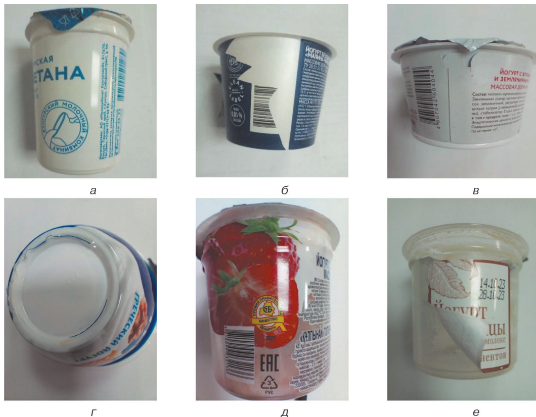
Рис. 6. Виды оформления упаковки: а – печать на таре; б – вплавляемая этикетка (IML); в – картонная этикетка; г – полипропиленовая этикетка (ПП); д – этикетка из поливинилхлорида (ПВХ); е – термоэтикетка Источник: составлено С.В. Польшгаловым, Г.В. Ильных.
