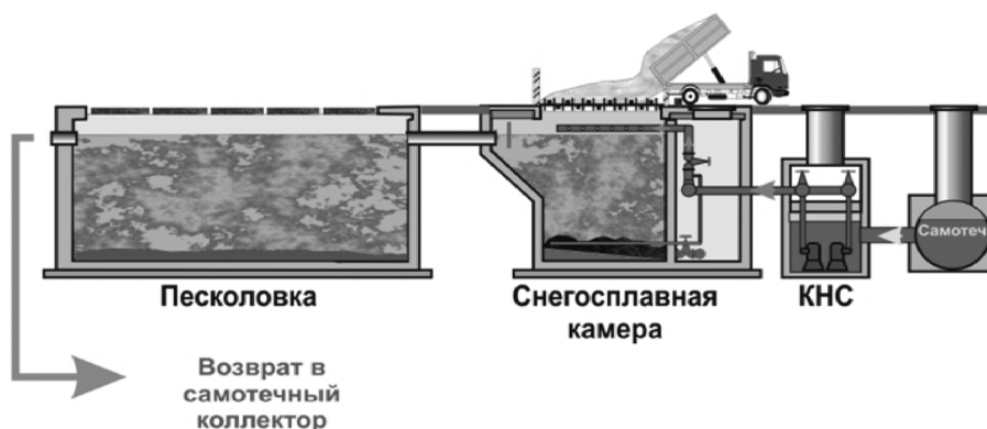
Рис. 1. Стационарное снегоплавильное сооружение на канализационном коллекторе
