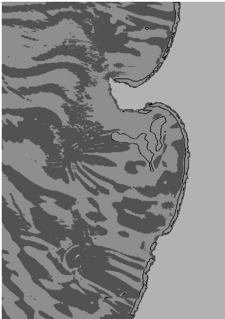
Рис. 5. Распределение разностей между максимальными высотами, рассчитанными на детальной и промежуточной сетках. На этом рисунке более подробно показан сегмент расчетной области, обозначенный белым прямоугольником на рис. 4. Изолинии черного цвета соответствуют уровню 1 см.
