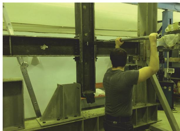
Рис. 3. Последовательность предварительной затяжки болтов. Монтаж узла
