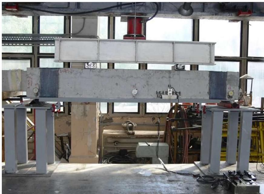
Рис. 4. Испытание железобетонной модели
