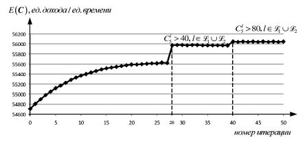
Рис. 2. **И**зменение суммарной интенсивности дохода при поиске решения задачи разделения ресурсов мультисервисной сети
