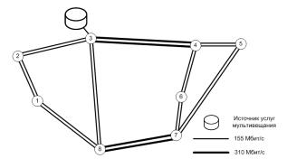
Рис. 1. Структура базовой сети телекоммуникаций
