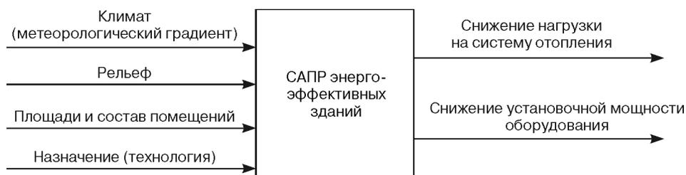
**Рис. 1.** Входы и выходы системы автоматизированного проектирования энергоэффективных зданий
