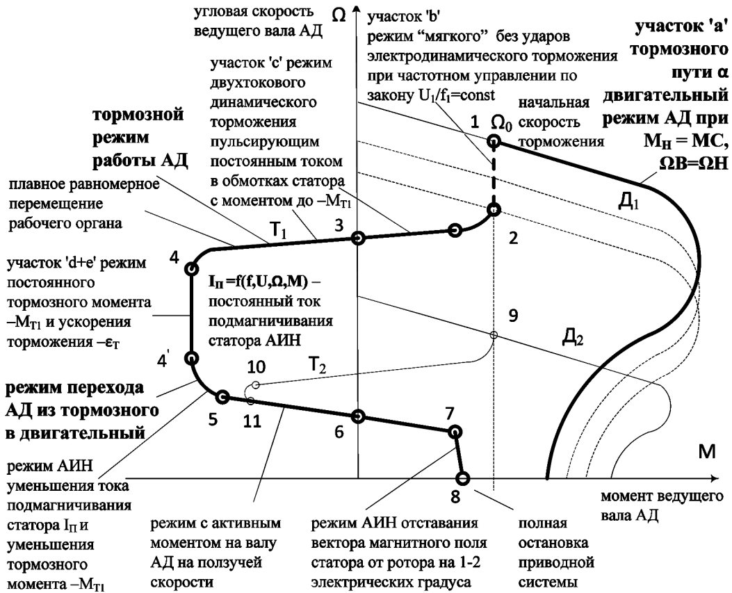
Рис. 4. Механические характеристики асинхронного трехфазного электродвигателя: Д — двигательный режим, Т — тормозной режим работы АД
