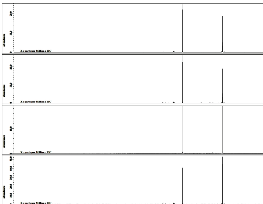
Рис. 6. Наложение спектров ЯМР ^{13}\text{C} , 600 МГц оригинальных духов и трех образцов духов, произведенных по лицензии в наиболее характерной области
